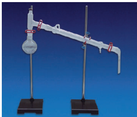
1 | Fabricado en vidrio borosilicato con uniones esmeriladas 29/32.
